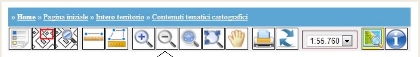
Il comando riduce la finestra attiva. L'utente deve digitare solo un punto sulla mappa e automaticamente il programma dimezza la scala di visualizzazione. Se, ad esempio, nella finestra precedente la scala di visualizzazione era 1: 250, attivando il comando "Riduce la zona cliccata" la scala di rappresentazione diventa 1:500. Il comando è attivabile in modo dinamico, usando la rotella del mouse.
